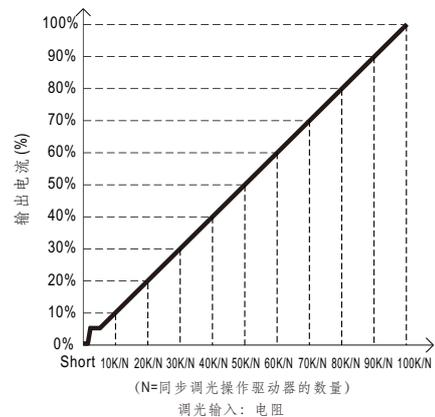
备注: 1.最小调光比例在8%左右, 当输出电流在 $0% < I_{out} < 8%$ , 输出电流精度不做定义。
